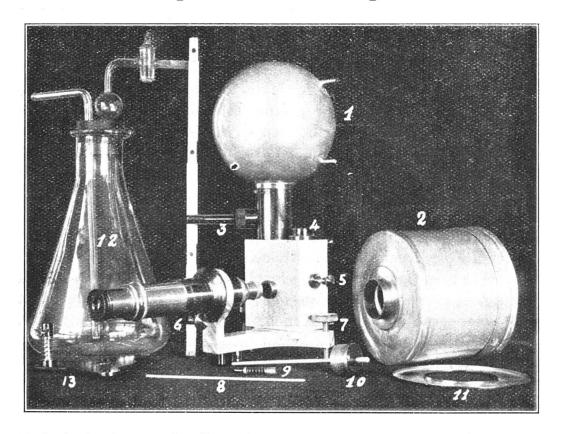
1. Ionisationskammer für Emanationsmessungen, 1 Liter Inhalt. (Für's Feldbezw. Laboratorium werden auch Kammern von 2 oder 5 Liter verwendet.)
