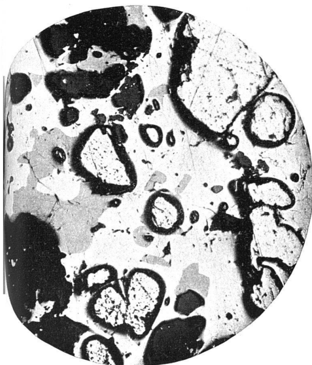
Phot. 3 Erz von Baicolliou Stark ankorrodierte Pyrite, in Grundmasse von Kupferkies (hell) und Fahlerz (hellgrau) schwarz = Quarz, dunkelgrau = Braunspat Anschliff 35 ×
