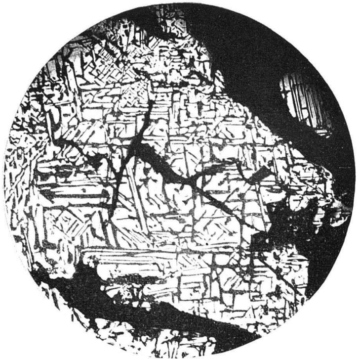
Phot. 13 „Weissnickel“ von Grand Praz Entmischungseinlagerungen von Ni-Erzen (dunkel, geätzt) in Co-Erz (hell) Anschliff 42 ×
