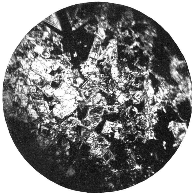
Phot. 17 Rammelsbergit von Fang (St. Luc). Ausgesprochen rhombische Form und zonarer Bau der Individuen Anschliff 200 \times
