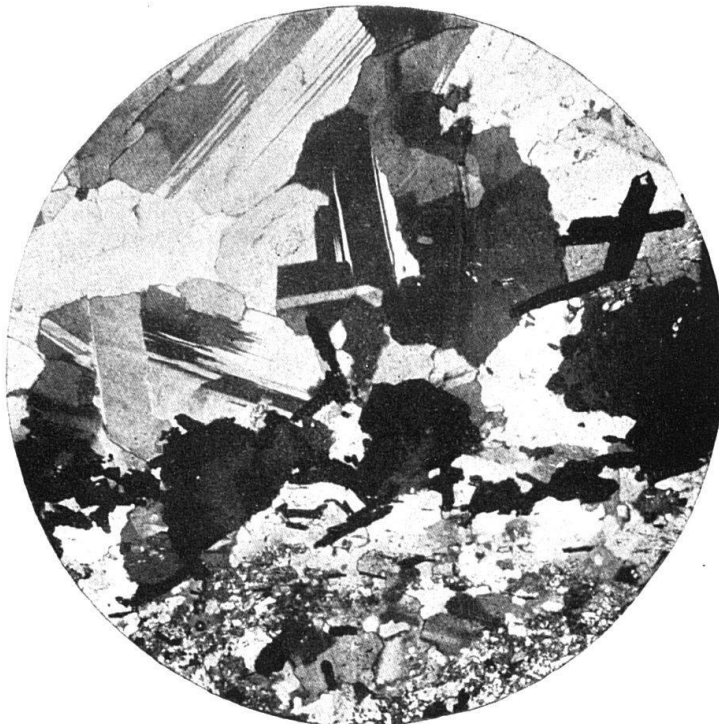
Phot. 2 Aplittischer Pegmatit, Rousson (Val d'Anniviers) Unten Zug von serizitisierten Feldspäten, parallel- struiert; oben regellos struierte Partie von wasserklaren Albiten Ganz schwarz = Eisenglanz Dünnschliff 33 ×
