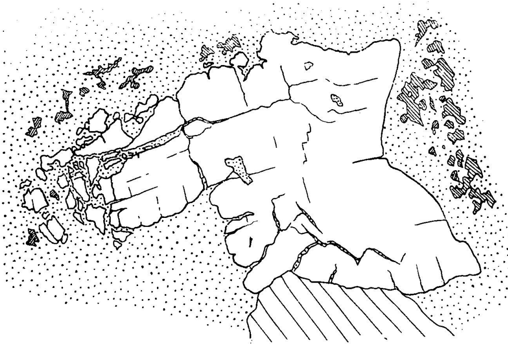
Fig. 7. Anschliffzeichnung: Aufgesprungener Pyrit, von Zinkblende ankorrodiert. Punktiert = Zinkblende; schraffiert rechts oben — links unten = Fahlerz; schraffiert links oben — rechts unten = Kupferkies. Moulins St. Luc. Vergr. 53 \times .
