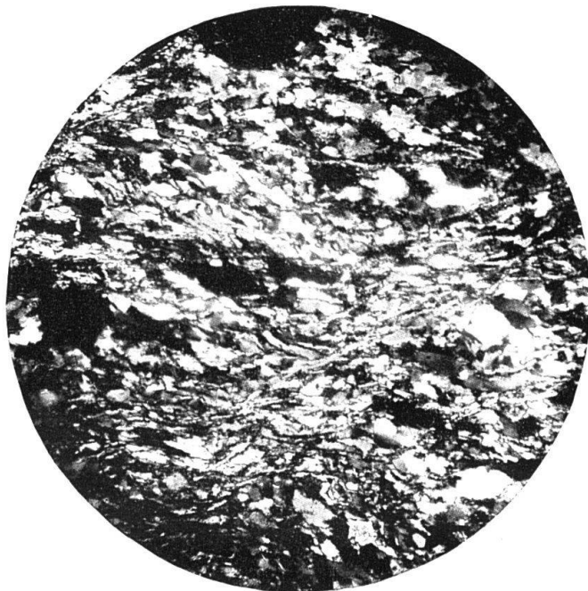
Phot. 19 Quarzreiches Nebengestein des Ganges von Baicolliou In der Horizontalen parallel angeordnete Quarze mit ausgesprochen undulöser Auslöschung. Schief zu dieser Richtung (rechts oben — links unten) Anordnung der Serizite. Transversalverschiebung jünger als Quarze. Dünnschliff 33 \times
