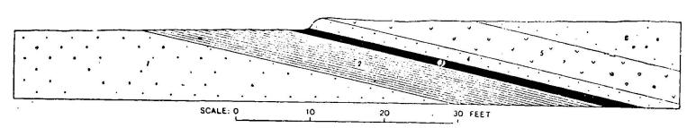
Fig. Nº XI. — Profil à travers le niveau platinifère de l'Horizon Supérieur d'après Percy A. Wagner. 1 = Norite tachetée à grain moyen. 2 = Pyroxènites pseudoporphyritiques et feldspathiques qui passent vers le haut à 3. 3 = Norite pyroxènite pseudoporphyrique et platinifère (Horizon supérieur). 4 = Norite tachetée de couleur claire. 5 = Anorthosite bigarrée. 6 = Norite tachetée à grain grossier.
