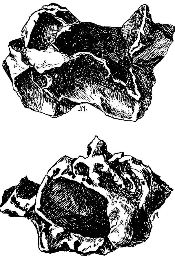
Fig. N° VIIa et b. — Pépites provenant des Pyroxénites montrant les cloisons et les cavernes provenant de la désagrégation du Pyroxène moulé par le Platine.
