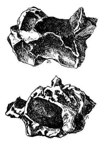
Fig. Nº VIIa et b. — Pépites provenant des Pyroxènites montrant les cloisons et les cavernes provenant de la désagrégation du Pyroxène moulé par le Platine.
