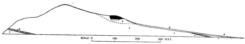
Fig. Nº IX. -- Profil à travers le gisement dunitique d'Onverwacht appartenant à l'Horizon Inférieur d'après A. Wagner. 1 = Bronzitite à Chromite avec lentilles de serpentine silicifiée. 2 = Horizon Inférieur des Chromites. 3 = Roches à Bronzite et Olivine passant vers le haut partiellement à la Dunite à Olivine serpentinisée. (La limite de cette roche est incertaine.) 4 = Dunite à Hortonolite platinifère. (Limite Inf. incertaine également). 5 = Horizon Supérieur des Chromites. 6 = Eluvions.
