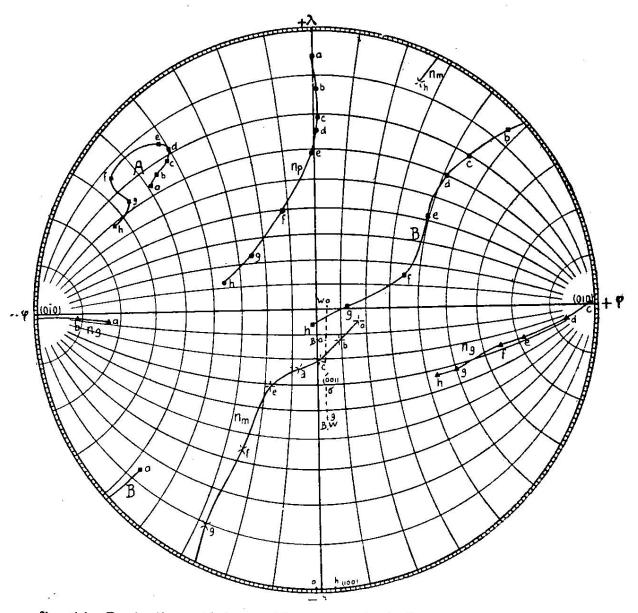
fig. 14. Projection stéréographique, montrant la migration de ng, nm et np et des axes optiques A et B, de la face (100) et du plan d'association σ de la macle de la péricline (W d'après les données de Wülfing, B d'après celles de Becke), la face (010) étant fixe.
