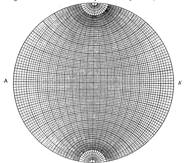
fig. 12. Canevas de Wulff. A-A' = diamètre équatorial.
