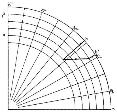
fig. 6. Abaque de Fédorof pour résoudre graphiquement la formule  $\frac{\sin h}{\sin h'} = \frac{n}{\mu}$  (correction de la réfraction pour l'angle h).
