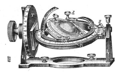
fig. 3. Vue perspective de la platine théodolite.
