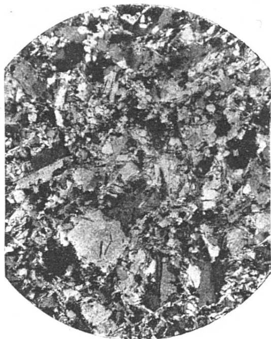
No 6. Aplite en filon dans les roches vertes. Mine Remington. La coupe montre les petites lamelles de muscovite calées entre les cristaux d'orthose, de plagioclase et de quartz. Structure granulitique. Objectif Zeiss C oculaire O.
