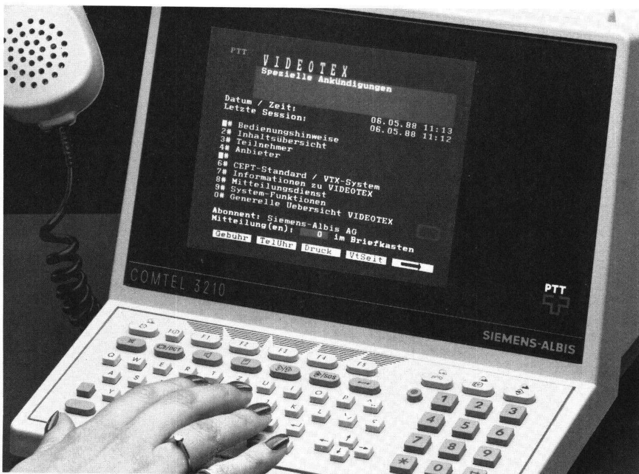
Telefonieren einerseits, Daten-, Text- und Bildaustausch im Videotextbetrieb andererseits oder gleich beides zugleich: Das COMTEL® 3210 von Siemens-Albis stellt das ideale Instrument für eine umfassende Telekommunikation dar. An jedem analogen Telefonanschluss anschliessbar, lässt es sich als Komforttelefon mit Namenregister von über 500 Zeilen wie auch als Videotex-Endgerät mit Makroregister für
