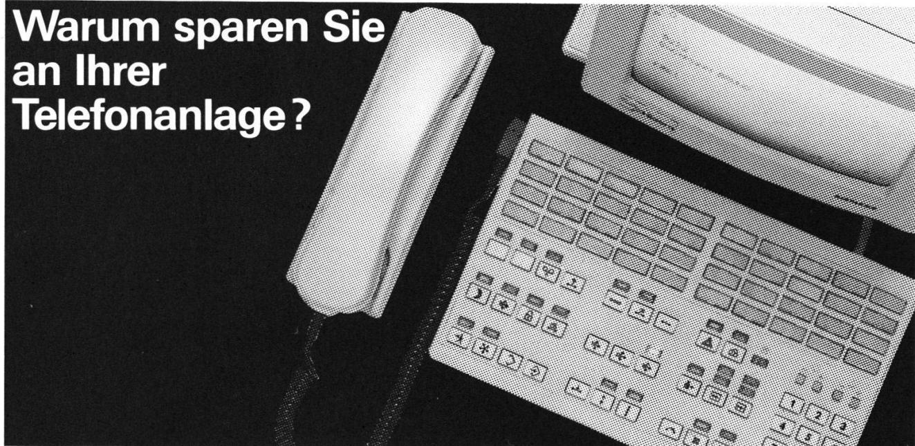
Im Zentrum aller Telefonanrufe, das Vermittlungsterminal von Hicom! Mit Bildschirm zur Information der Telefonistin über anstehende Anrufe. Einfache Vermittlungsprozeduren, komfortable Bedienerführung. 40 programmierbare Namentasten.
