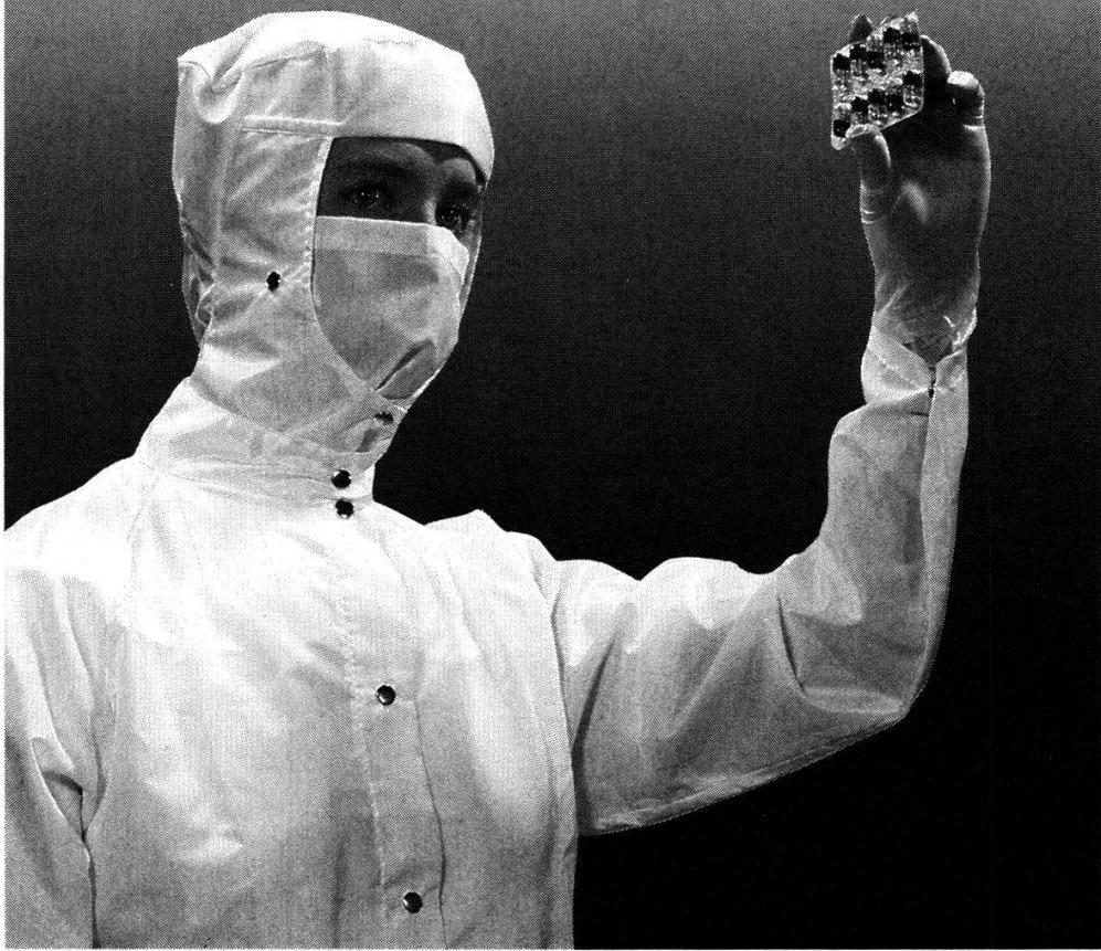
**M**enschen in Operationssälen vor Bakterien. Mikrochips vor Staubkörnchen. Impfstoffe vor Killerpartikeln. Dazu bedienen wir uns der Reinraumtechnik. Mit Hilfe spezieller raumluftechnischer Anlagen filtern wir Luft so gründlich, dass alle freischwebenden Partikel bis 0,0002 mm Ø abgefangen werden. Was Menschen, Geräte und hochempfindliche Prozesse zuverlässig schützt.
