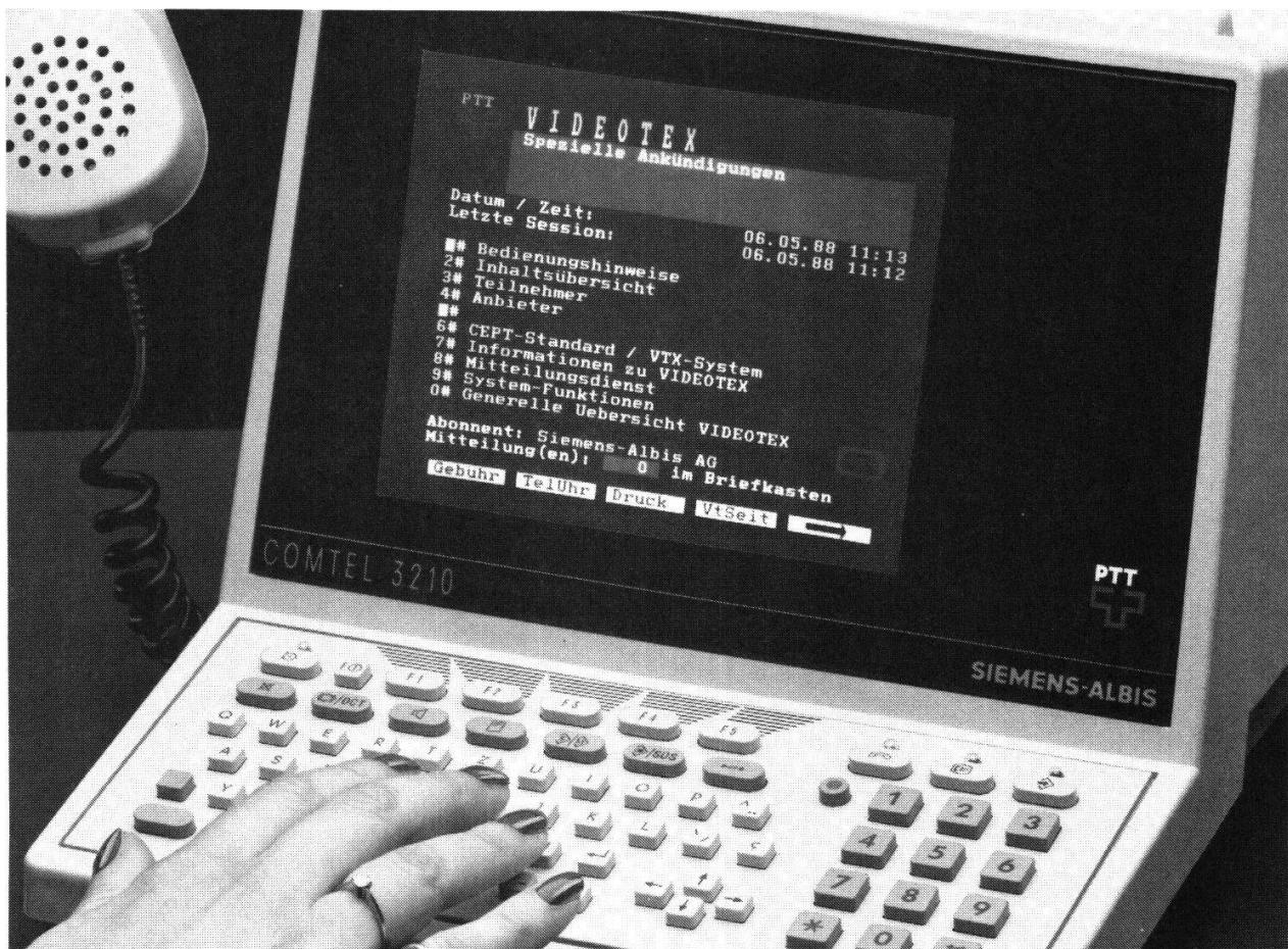
Telefonieren einerseits, Daten-, Text- und Bildaustausch im Videotexbetrieb andererseits oder gleich beides zugleich: Das COMTEL® 3210 von Siemens-Albis stellt das ideale Instrument für eine umfassende Telekommunikation dar. An jedem analogen Telefonanschluss anschliessbar, lässt es sich als Komforttelefon mit Namensregister von über 500 Zeilen wie auch als Videotex-Endgerät mit Makroregister für
