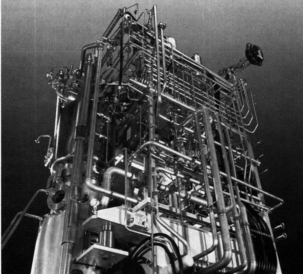
Die Mikro-Organismen darin. Sie setzen biochemische Prozesse in Gang, mit deren Hilfe rein biologische Produkte (zum Beispiel Insulin, Interferon, Impfstoffe usw.) erzeugt werden. Die Voraussetzungen dafür bietet Sulzer mit seinen biotechnischen Forschungen sowie den entsprechenden Verfahrensanlagen wie der hier abgebildeten Anlage zur natürlichen Fermentation.
