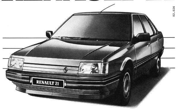
7 Modelle, <u>Einspritz-Motoren 1721 cm³</u> (95 PS/70 kW) und <u>2165 cm³</u> (110 PS/81 kW), beide mit geregeltem 3-Weg-Katalysator (US 83), Automatikgetriebe auf Wunsch. <u>2068 cm³ Turbo-Diesel</u> (88 PS/65 kW). **Ab Fr. 18 950.—**
