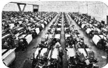
Websaal mit Schützenwebmaschinen Rütli - C1000
