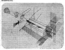
Diese Verfahren gewährleisten eine höhere Produktion bei ruhigerem Lauf und grosser Wirtschaftlichkeit, Mit dieser neuen Generation von +6F+ Webmaschinen aus Rüti werden 800–900 Meter Schussfaden pro Minute verwebt,
