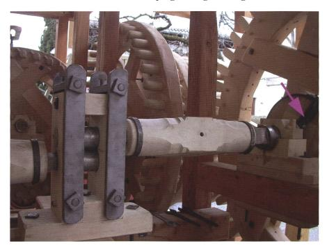
Abb. 6: Prägestock mit zwei eingespannten Walzen. Nachbau der Walzenprägemaschine im Museum Burg Hasegg in Hall in Tirol
