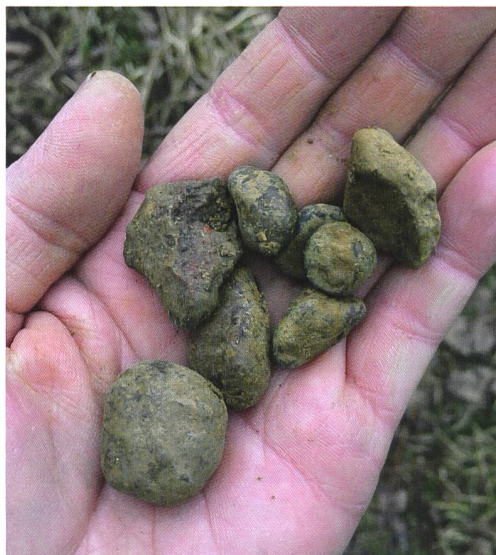
Abb. 1: Bohnerz, erbsen- und bohnenförmige Eisensteine von hohem Eisengehalt 2 .
