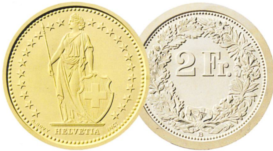
Abb. 38/39: Links: Die Modelle von Bild- und Wertseite in gelbem bzw. weissem Kunststoff, Durchmesser 200 mm; rechts: Fräsen der Reduktion der Zweifranken-Wertseite ab den digitalen Daten.
