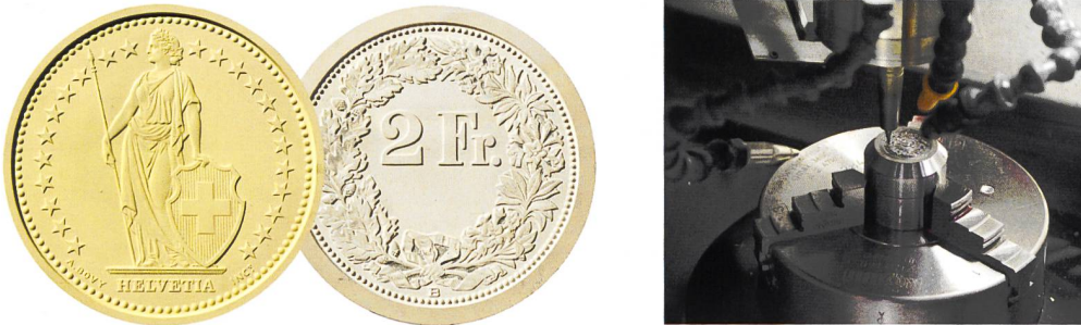
Abb. 38/39: Links: Die Modelle von Bild- und Wertseite in gelbem bzw. weissem Kunststoff, Durchmesser 200 mm; rechts: Fräsen der Reduktion der Zweifranken-Wertseite ab den digitalen Daten.
