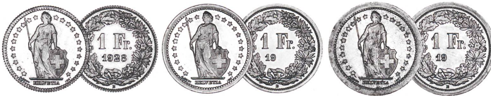
Abb. 20: Probeprägungen aus Reinnickel im Zusammenhang mit der geplanten Münzgesetzrevision von 1931: Von links nach rechts: Mit grob geripptem Rand; mit breitem und mit sehr breitem Randstab (beide ohne Rippen) 49 .
