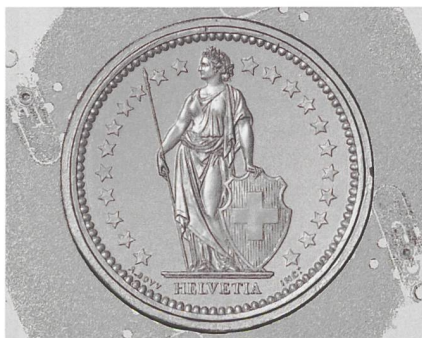
Abb. 34/ 35: Das eingescannte Helvetiamodell links wird vom Swissmint-Graveur Remo Mascherini mit einer speziellen CAD-Software überarbeitet.
