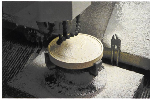
Abb. 36/37: Fräsen des Kunststoffmodells ab den digitalen Daten.
