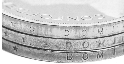
Abb. 4: Vertiefte Randschriften eines echten Fünffrankenstücks (oben) und von zwei falschen Stücken (Mitte und unten) 18 .
