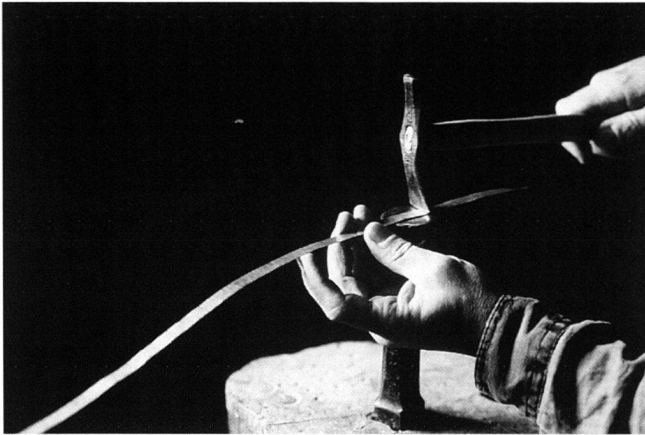
Abb. 6–7. Der König wird zum Zain ausgeschmiedet.
