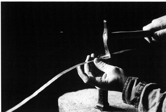
Abb. 6–7. Der König wird zum Zain ausgeschmiedet.
