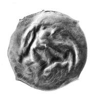
Abb. 8d. Durch die massive Dehnung wird der Schrötling wellenförmig deformiert. Oben und unten die gezähnten Kanten. Mst. 2:1.
