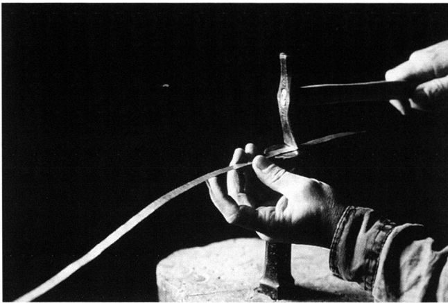
Abb. 6–7. Der König wird zum Zain ausgeschmiedet.
