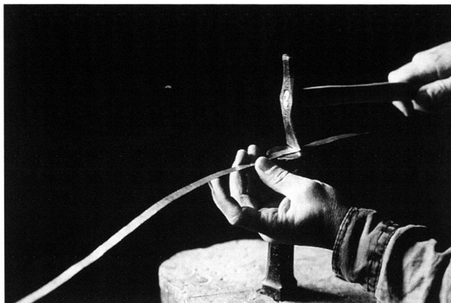
Abb. 6–7. Der König wird zum Zain ausgeschmiedet.
