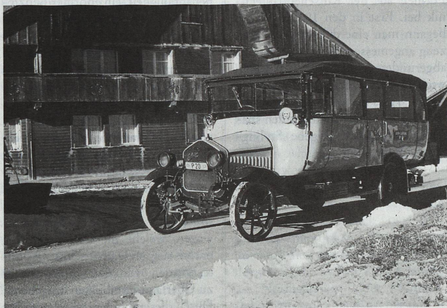
1918 bis 1920 erhielt die Postverwaltung 100 Armeelastwagen, die sie zu Postautos umbauen konnte. Im Bild eines der ersten Postautos: Ein Saurer P 20 aus Arbon. 1983 stellte Saurer die Produktion von eigenen Nutzfahrzeugen ein. Foto: Postauto-Bildarchiv, Bern
