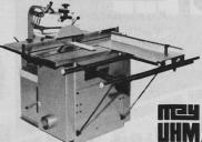
3- bis 5fach kombinierbar mit 350 mm Hobelbreite, SUVA-Schutzvorrichtungen, Rolltisch, 2 Motoren usw.
