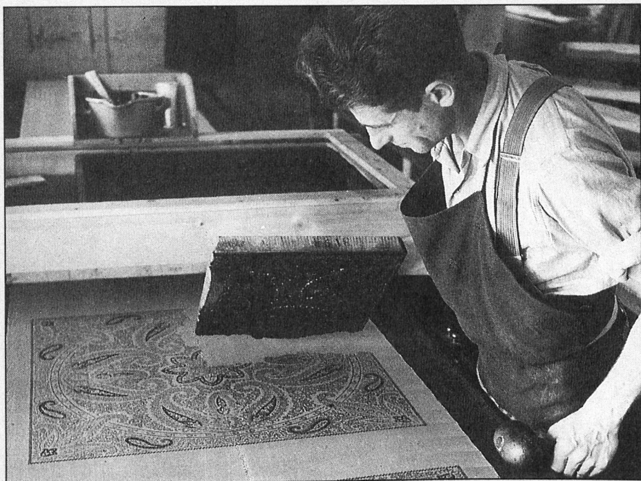
Historischer Modeldrucker. Das Bild links zeigt den Druckvorgang. Das präzise Ansetzen der einzelnen Druckmodel erfordert eine grosse Geschicklichkeit des Stoffdruckers.
