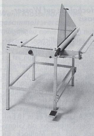
Für den Werkraum bietet IDEAL ebenfalls ein ausgezeichnetes Hebeleinschneidermodell an. Die IDEAL 1080 U ist die Standard-Werkstoffschneidemaschine mit 80 cm Schnittlänge für Schulen und Werkräume.
