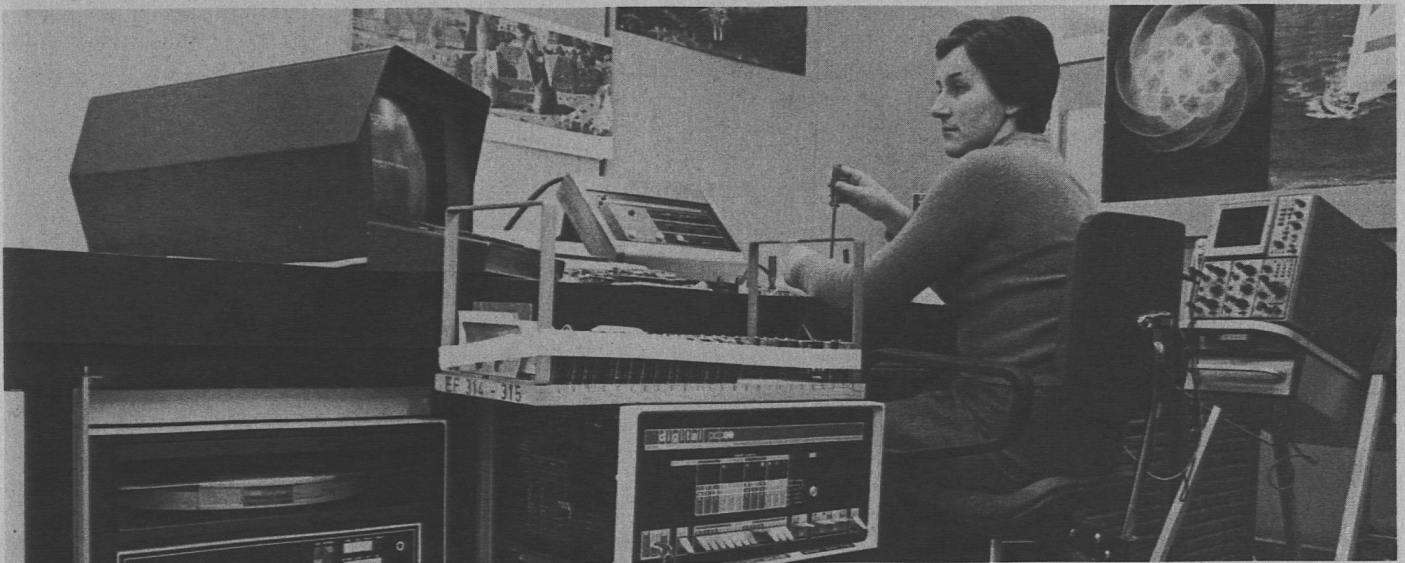
Automatic-Test-System zum Prüfen und Reparieren von elektronischen Printbaueinheiten der Daten-, Nachrichten-, Schutz- und Kraftwerkelektronik. Unser Bild zeigt Milena Trivanovic als Operatrice an ihrem Arbeitsplatz in ESX-5 in Gebenstorf.
