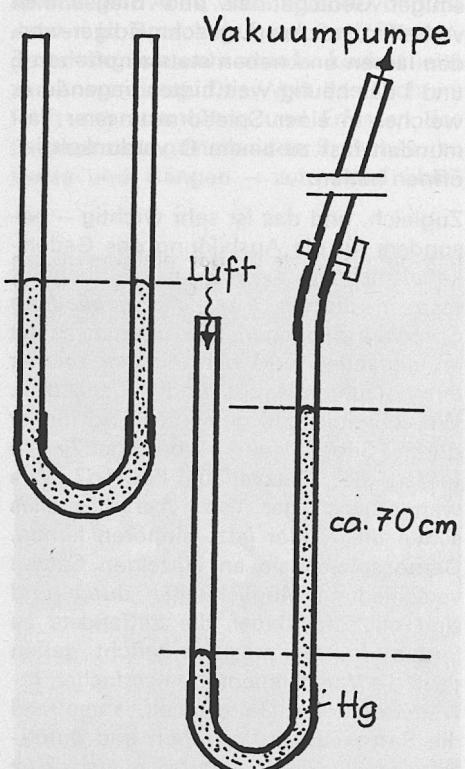
9 Beim Pumpen steigt die rechte Hg-Säule, bleibt aber bei einem Höhenunterschied von etwa 70 cm stehen, auch wenn man weiterpumpt! Das Hg «will» plötzlich nicht mehr in den luftleeren Raum steigen!
