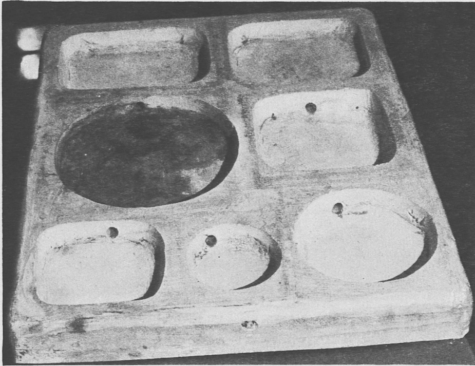
Abb. 7 Mehrkammeriges Gipsnest. Zirka 70 \times 60 \times 10 cm. Durchmesser der Kavernen 25–30 cm. Das Nest wird mit einer starken Glasplatte (Doppelglas) und schwarzem Papier oder Tuch abgedeckt. Flizstreifen am Deckglas verhindern das Entweichen der Ameisen. Die oberen Kavernen dienen als Futterplätze. Als Versuchsanlage für Orientierungsversuche ist die Anlage nicht geeignet.
