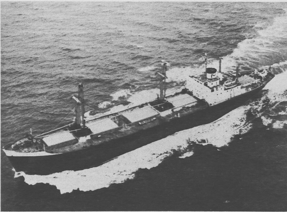
SD-14-Frachtschiff «Industria», ausgerüstet mit einem Vierzylinder-Sulzer-Clark-Dieselmotor vom Typ RND68M. Bis heute wurden 100 Schiffe dieses Typs gebaut.
