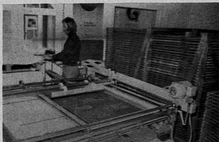
Siebdruckmaschine im Atelier Edwin Vogt Partner, Waldenburg, auf welcher die Serigrafie «Drei horizontale Teilungen 1975» gedruckt wurde. Es handelt sich um einen Halbautomaten, das heisst der Rakelvorgang und die Luftzu- und -abfuhr für das Ansaugen des Druckgutes werden automatisch gesteuert, die Druckbogen werden jedoch von Hand ein- und ausgelegt. In der Maschine eingespannt ist das Sieb für die gelbe Farbe unseres Lohse-Blattes. Am hinteren Rand des Siebrahmens liegt die Rakel.
