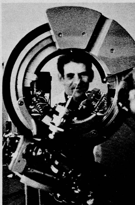
Physikalisch-chemische Pharmaforschung. Die Beugung von Röntgenstrahlen im Wirkstoffkristall ergibt die Information, die nötig ist, um die dreidimensionale Molekülstruktur aufzuklären. (Foto «Roche»)
