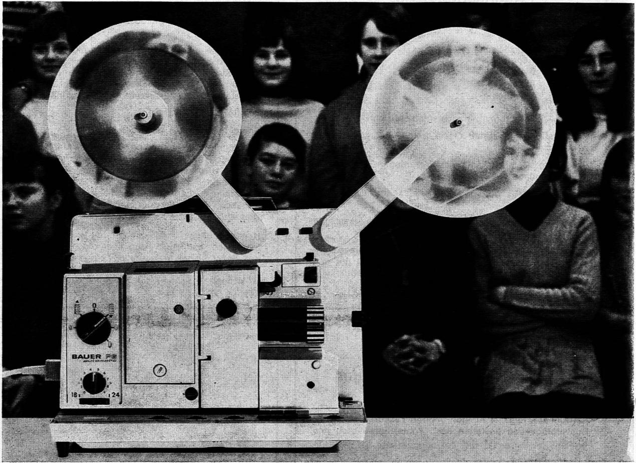
**1** Den P6 können Sie überall einsetzen. Von der kleinen Schultube bis zum grossen Saal. Seine Lichtleistung überzeugt auch den Zuschauer auf dem hintersten Platz. Und das Bild wird nicht nach einigen Vorstellungen dunkler, weil sich die Lampe schwärzt. Der P6 hat eine Halogen-Lampe, die von der ersten bis zur letzten Stunde hell leuchtet. 50% heller und 300% länger als gewöhnliche Lampen.
