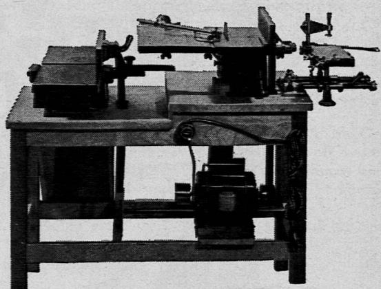
Beide Maschinen auf einem Holztisch montiert und von einem Motor angetrieben.
