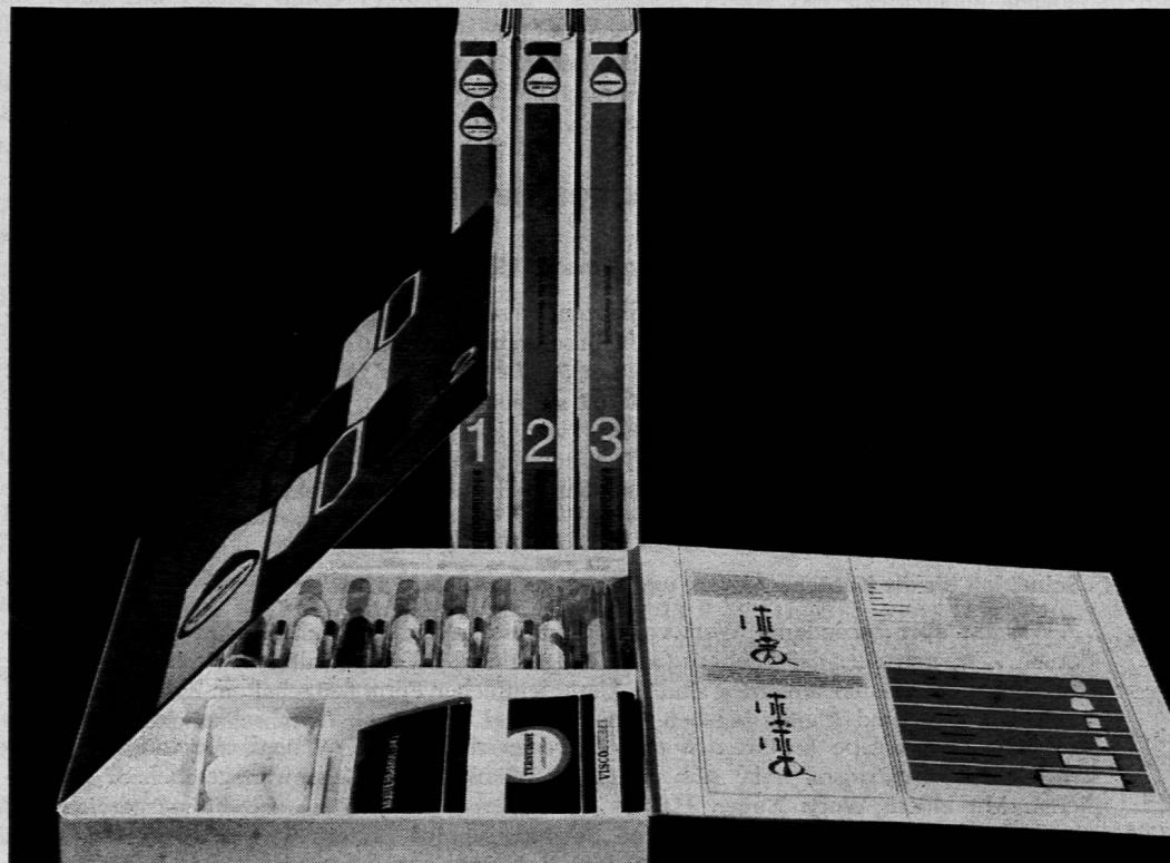
In der dreiteiligen Schulkollektion wird die Entstehung von Viscosefasern (Rayonne, Fibranne), Polyamidfasern (Nylon) und Polyesterfasern dargestellt. Die einzelnen Stufen der Fabrikation (Rohstoffe, Zwischenfabrikate) und die verschiedenen Gartypen werden anhand von Mustern anschaulich gezeigt. Eine kleine Musterkollektion weist auf die vielseitigen Einsatzgebiete von Chemiefasern hin.
