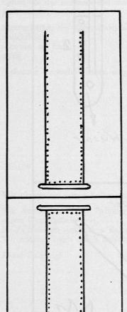
Glaszylinder innen anfeuchten. Eisenpulver darin schütteln. Es haftet an den feuchten Wänden. Rest weg.
