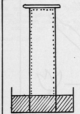
Umgekehrt ins Wasser stellen. Mit dünnem, gebogenem Glasrohr Wasserspiegel innen und aussen gleich richten. Messung! Längere Zeit stehenlassen. Beobachten. Wasser steigt im Glas. Ein Teil der Luft wird verbraucht.
