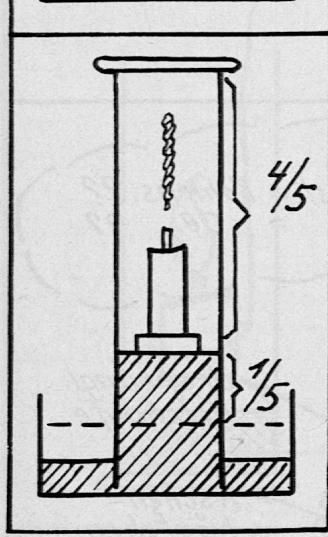
Ohne Luft keine Flamme. Die Flamme verbraucht einen Teil der Luft. Die Luft besteht aus einem Fünftel Sauerstoff und vier Fünfteln Stickstoff. Sauerstoff wird verbraucht, Stickstoff bleibt übrig.
