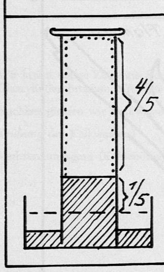
Eisenfeilspäne rosten. Ein Fünftel der Luft wird dabei aufgebraucht. Oxydation. (Langsame Verbrennung)
