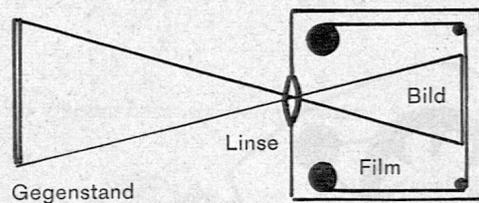
Der Photoapparat ist ein grobes Modell des menschlichen Auges. Das verkleinerte Bild eines Gegenstandes fällt auf die Netzhaut. Die Lichtreize werden durch Nervenzellen aufgenommen und zum Gehirn geleitet.
