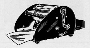
druckt in einem Arbeitsgang — ohne Farbe und Matrizen — mehrfarbige Auflagen vom kleinsten Format bis  $30 \times 20~\mathrm{cm}$
