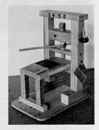
Die Druckpresse Gutenbergs entstand nach verschiedenen zeitgenössischen Darstellungen und einer Nachbildung im Gutenbergmuseum in Mainz aus alten Latten und aus Stücken eines ausgeschossenen Reissbrettes. Das Gewinde der Spindel wurde mit der Raspel ausgeraspelt. Auf dem verschiebbaren Druckerkarren liegt ein herausnehmbarer «Satz», der in Linoleum geschnitten ist. (Höhe der Presse
