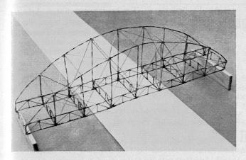
8. Eisenbahnbrücke. Die Bodenkasten einzeln vorfabriziert, als eigenstarres Element «multipliziert» und entsprechend dem Lastanfall mit Bogen verstärkt. Die Längsholmen sowie der Bogen sind doppeldrahtig.
