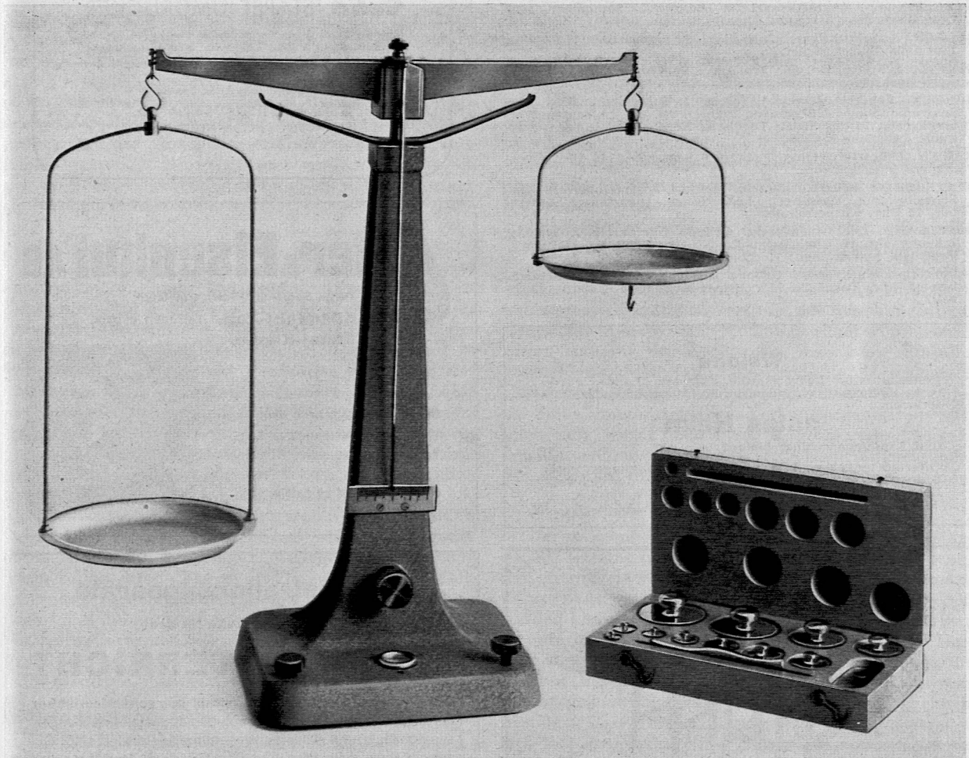
Hebelwaage der Metallarbeiterschule Winterthur. Tragkraft 250 g pro Schale. Empfindlichkeit 10 mg. Ausrüstung: Arretierung, Fahne, Libelle, Zeiger, Skala, 2 Stellschrauben.
