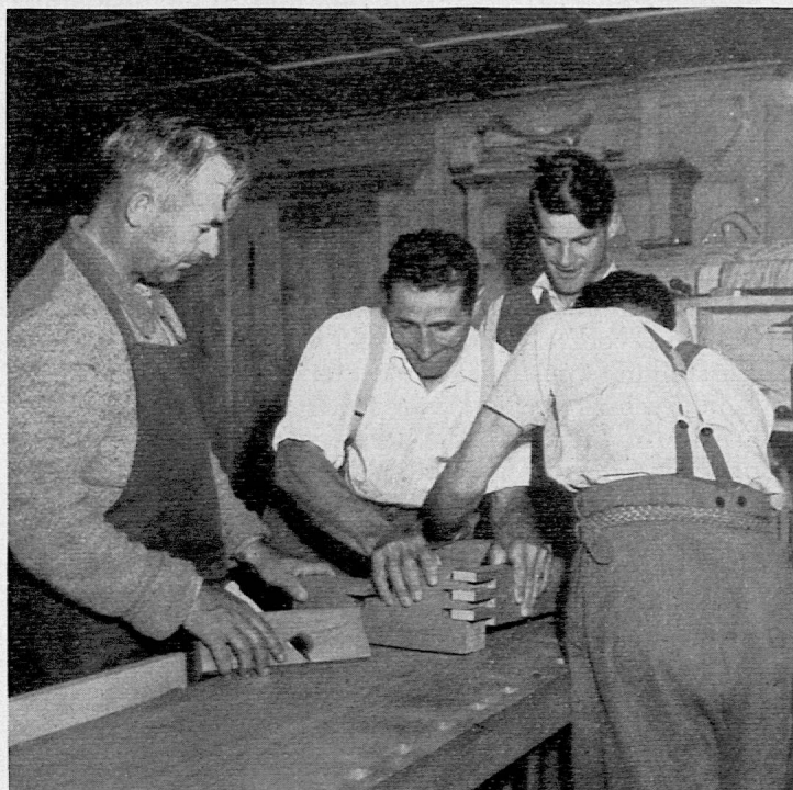
Holzbearbeitungskurs des Heimatwerkes im Prättigau. — Fortschreitend erlernen die Schüler die grundlegenden Holzverbindungen. Hier wird an einem Probestück das für alle Eckverbindungen unentbehrliche «Zinken» gezeigt.
