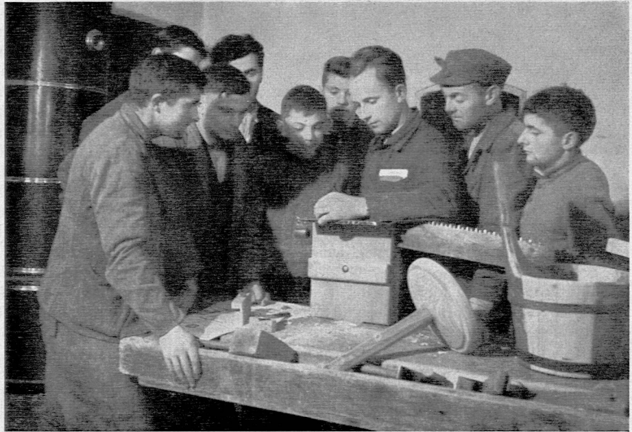
Die Waldsäge ist im selbstgemachten Feilenhalter eingespannt. Wie wichtig ist gut instandgehaltenes Werkzeug!
