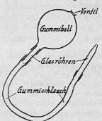
Auch Reinigung mit Pinseln hilft nicht viel. Zweckmässig ist dagegen das Ausblasen des Okulars und des Mikrometers mit dem scharfen Luftstrahl eines einfachen, nach beistehender Zeichnung hergerichteten Handgebläses. — Dass man die von Schülern beschmutzten Frontlinsen der Objektive nur mit Wasser oder Benzin, niemals mit Alkohol reinigen darf, ist bekannt.
