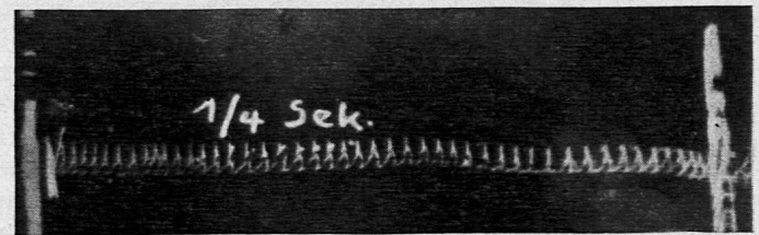
Fig. 2: Aufzeichnung eines schwingenden Bienenflügels auf eine bewegte Russplatte: 45 bis 46 Schwingungen in \frac{1}{4} Sekunde. Natürliche Grösse. — Photo H. Pärli.
