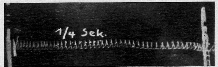
Fig. 2: Aufzeichnung eines schwingenden Bienenflügels auf eine bewegte Russplatte: 45 bis 46 Schwingungen in \frac{1}{4} Sekunde. Natürliche Grösse. — Photo H. Pärli.
