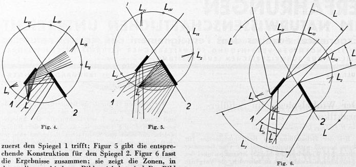
zuerst den Spiegel 1 trifft; Figur 5 gibt die entsprechende Konstruktion für den Spiegel 2. Figur 6 fasst die Ergebnisse zusammen; sie zeigt die Zonen, in denen die verschiedenen Bilder sichtbar sind. Das Bild  $L_{121}$  wird in diesem Falle wegen der begrenzten Spiegelflächen gar nicht vorhanden sein. Wiederum ist eine genaue Kontrolle der Resultate mit monokularer Beobachtung möglich.
