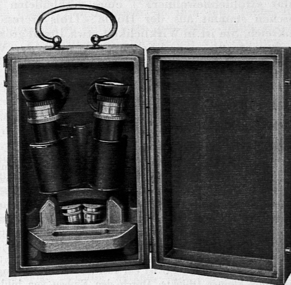
Die Binokularlupe im Versorgungskasten. Unten das einschiebbare Holzstativ, welches behelfsmässig ein richtiges Stativ ersetzen kann.
