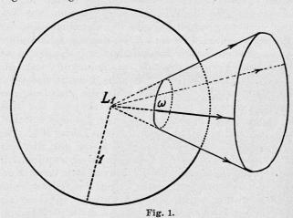
Um den einfachsten, die elementare Optik am meisten interessierenden Fall zu haben, wird man die Punktförmigkeit der Lichtquelle und die Isotropie des Licht nicht absorbierenden Mediums postulieren. Dann geht die Lichtröhre in einen sogenannten Lichttrichter über, der durch einen räumlichen Winkel dargestellt wird (Fig. 1).
