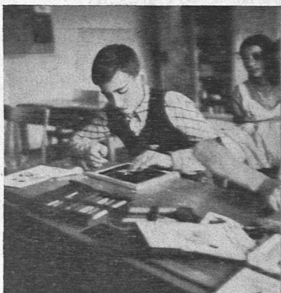
Das Unterlagebrettchen hält den Druckstock.
