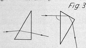
des Brechungsgesetzes. Dabei wird man insbesondere auch Fälle mit Reflexionen berücksichtigen, da sie das prinzipiell wichtige Ergebnis liefern, dass die Reflexion im Inneren des Glases ebenfalls dem Reflexionsgesetz genügt. Fig. 3 deutet als Beispiele einige beobachtbare Fälle an, zu denen sich leicht weitere finden lassen.
