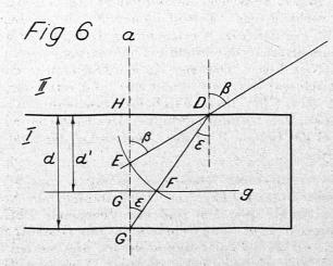
dass d' : d = n. Für einen beliebigen Strahl GD wird ED die Richtung des gebrochenen Strahles. Es ist nämlich nach der Figur:
