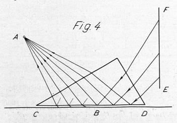
genstand G» visieren wir nun von allen Seiten durch die Fläche B C hindurch und zeichnen auf dem Zeichnungsblatte G, B C und das System der gebrochenen Strahlen. Letztere umhüllen eine Kurve, welche in G' eine Spitze besitzt. Die Uebereinstimmung des Versuchsergebnisses mit dem Brechungsgesetz erkennt
