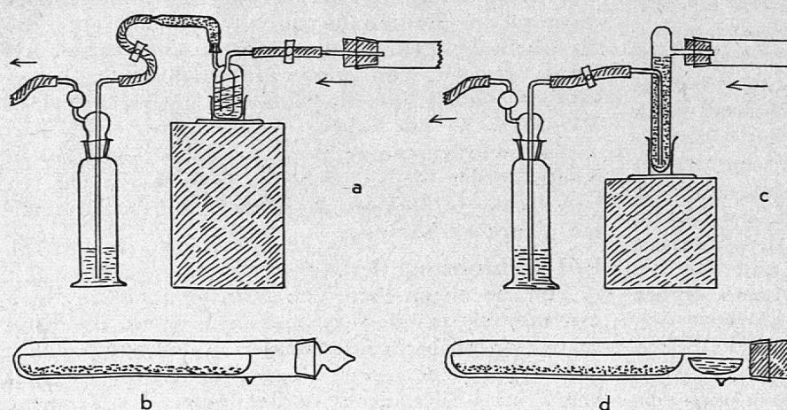
wird der Ofen eine Stunde lang auf 1100° angeheizt, so dass das Kohlendioxyd sich abspalten und mit dem Luftstrom in den Kaliapparat übergeht. Nach dem Ausschalten des elektrischen Stromes lässt man den Ofen während 25 Minuten sich abkühlen und schickt
