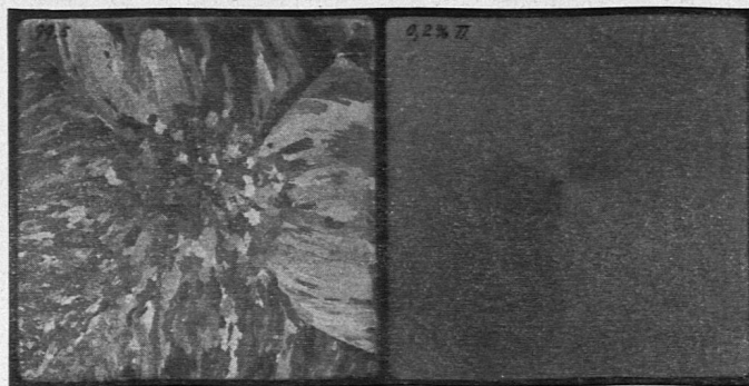
Fig. 4. Stellt den Einfluss von Ti auf die Korngrösse von Rein-Al (99,5%) bei Kokillenguss dar. Links ohne und rechts mit 0,2 % Ti-Zusatz. \frac{1}{2} nat. Grösse.
